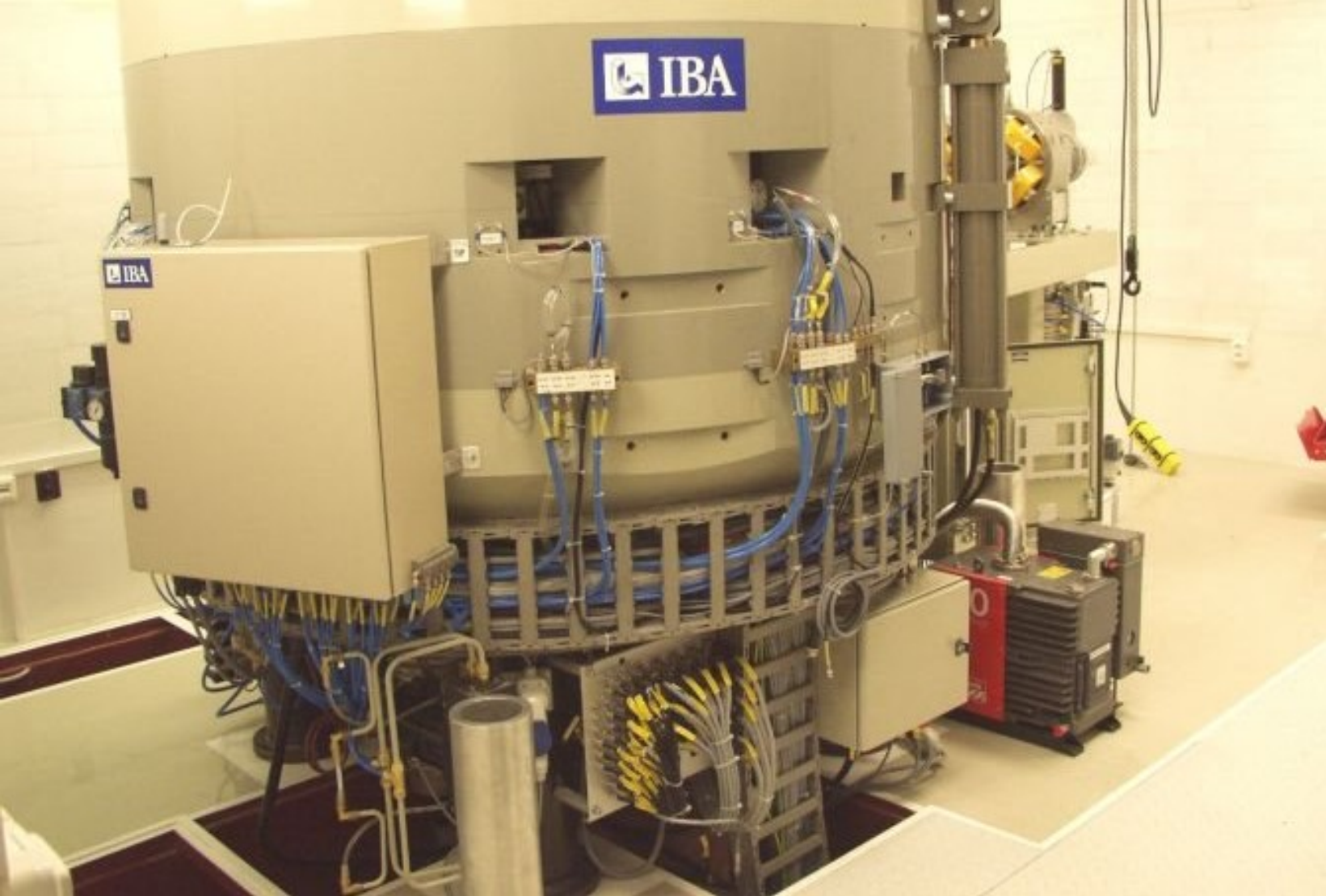
18 MeV-es baby-ciklotron PET-izotópok gyártására
